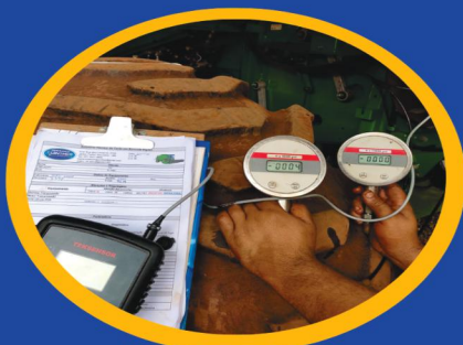
Aferição e manutenção preditiva do sistema hidro
